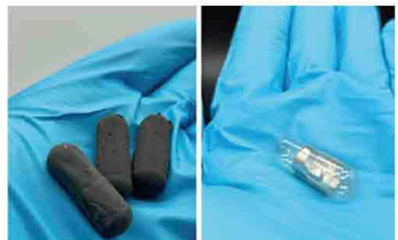
MIT / Giovanni Traverso and Mehmet Granhan Say 包覆的黑色外層（左）溶解後，膠囊裡的天線和晶片（右）就會發出被服用的訊號。
