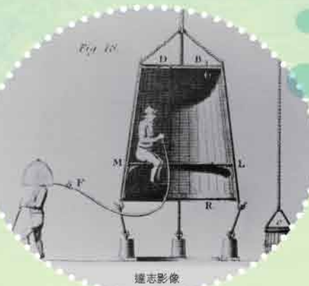
▶潛水鐘讓西方人開始進行最早的海底探勘。十八世紀某位發明家的設計圖中，一個人坐在潛水鐘裡，另一個人頭上戴著裝有空氣的小桶，可以在水中行動。
